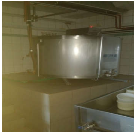
Slika 1. Kazan za sirenje mlijeka kapaciteta 1.000 l Picture 1. Cheese vat with 1.000 l capacity
